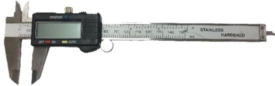
**Figura 4.** Vernier digital. Fuente: Fotografía propia.
