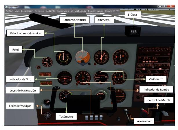
Ilustración: Vista general de cabina Cessna 172: los instrumentos indicados en verde son instrumentos de solo lectura, los instrumentos en naranja pueden ser calibrados directamente y los no señalados son instrumentos de radio ayuda (No tenidos en cuenta para las prácticas VFR)
